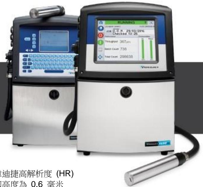
在噴印尺寸就是一切、清晰度就是關鍵的應用中，偉迪捷高解析度 (HR) 噴碼機專為此類應用而設計。該款噴碼機的最小噴印高度為 0.6 毫米 (1/32 英寸)，最高噴印速度為 348 米/分鐘 (1142 英尺/分鐘)，即便在最小的噴印區域進行噴碼也可確保編碼清晰可讀。我們的這款 HR 微字元噴碼機能夠噴印多達三行編碼，包括二維條碼和線性條碼，可滿足在更小空間噴印更多內容的需求。
